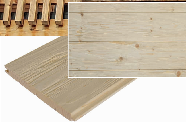
Blockwand / N+F-BRETT Fichte natur, gehackt, gebürstet Kl. AB, Nut und Feder 23 x 196 x 5000 mm | DB: 186 mm
