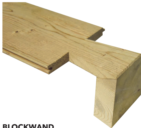
BLOCKWAND Lärche | gehackt mit Eckverbindung „Tiroler Schloss“ 195 x 4000 mm (2 St.RE/Pack, 2 St.LI/Pack)
