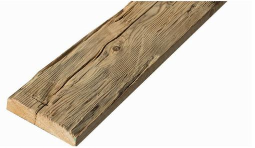
Sichtseite gebürstet · kammergetrocknet (12% ±2%) · Rückseite gehobelt · besäumte Ware
