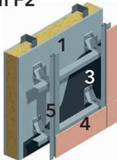
Aufbau der vorgehängten hinterlüfteten Fassade (VHF)
