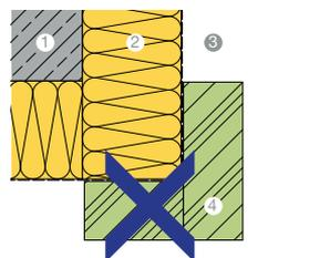
**VARIANTE MIT OFFENER FUGE UND ÜBERSTAND DER MAX EXTERIOR PLATTE**
