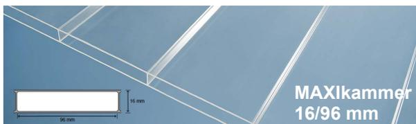
HIGHLUX® Acrylglas Stegdoppelplatten **16/96** mm, farblos, **MAXIkammer, schlagzäh, No-Drip**. UV-absorbierend. Die „klare“ Verglasung mit ca. 87 % Lichtdurchlässigkeit, ideal für Verglasungen im senkrechten Bereich, wenn hohe Durchsicht gewünscht wird. (Verlegung bis 3500 mm, ohne Querunterstützung bei Schneelast 75 kg/m²) Brandklasse nach DIN EN 13501-1: E
