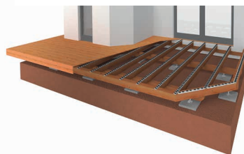
Auf instabilem Boden (nicht verdichteter Boden)
