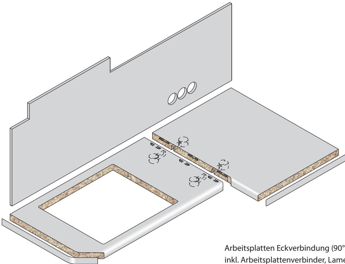
Arbeitsplatten Eckverbindung (90°)
