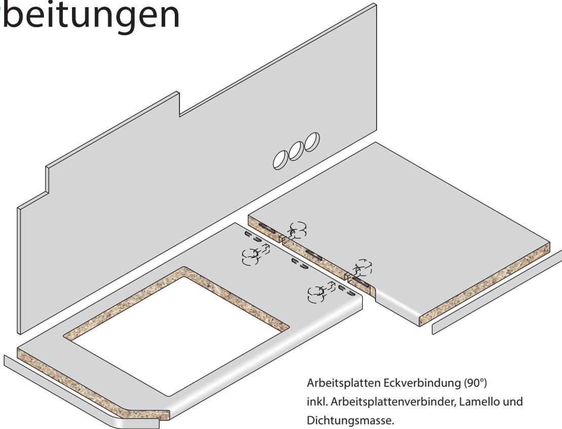
Arbeitsplatten Eckverbindung (90°)
